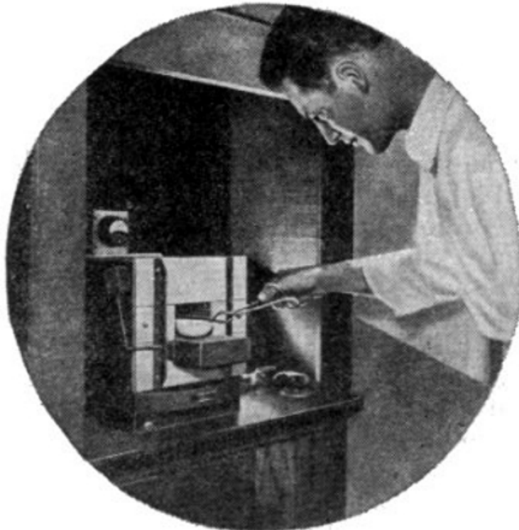
Figura 33.5 Horno para la obtención de molibdeno metálico
