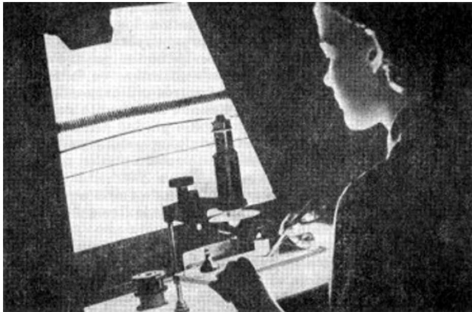
Figura 25.4 Verificación de un filamento de wolframio para lámparas eléctricas de incandescencia. En la parte superior se ve la silueta de un hilo arrollado en espiral, aumentado 80 veces, para lámparas de 60 vatios; en el centro, una vuelta de espiral. En la parte inferior se muestra un cabello humano, como término de comparación
